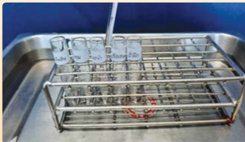
ภาพที่ 22 วางหลอดทดลองในอ่างน้ำอุ่นตามเวลาที่ระบุ เพื่อให้ GT-1 และ GT-2 ทำปฏิกิริยา
