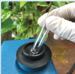
ภาพที่ 43 เขย่าน้ำยาสกัด ตัวอย่างอีกครั้ง
